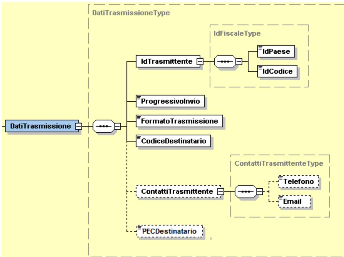
**Figura 2:** *Elemento DatiTrasmissione*
